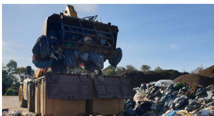
Prélèvement d'un échantillon de 500 kg
